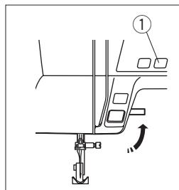
Stellen Sie den Nähfuß hoch. Drücken Sie die Taste Nadel Hoch/Tief der Nadel ①, um den Fadenhebel in seine höchste Stellung zu bringen.
