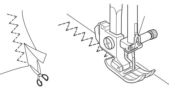
Deze steek wordt gebruikt om een zoom in synthetische stoffen en andere stoffen die gemakkelijk samentrekken af te werken. Deze steek is ook geweldig voor stopwerk en het herstellen van scheuren.
