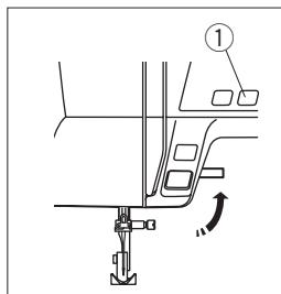
Relevez le pied de biche. Appuyez sur la touche de position haute/basse de l'aiguille ①. afin de relever le levier releveur de fil jusqu'à sa position la plus haute.
