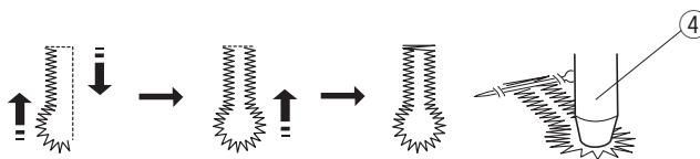
De naaiprocedure is gelijk aan die voor het vierkante knoopsgat. Gebruik het tornmesje en een oogje pons ④ om het knoopsgat te openen.
